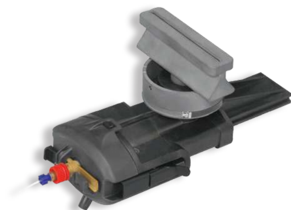
Хийн хоолой холбох шаардлагагүй тул PinAAcle 900-ийн шатаагч угсралтыг багажгүйгээр амархан салгаж, цэвэрлэх болон аналитикийн аргыг солиход хялбар.
